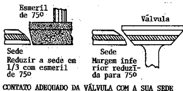
Figura 10-12 Esmerilhamento do canto interno da sede da válvula.
